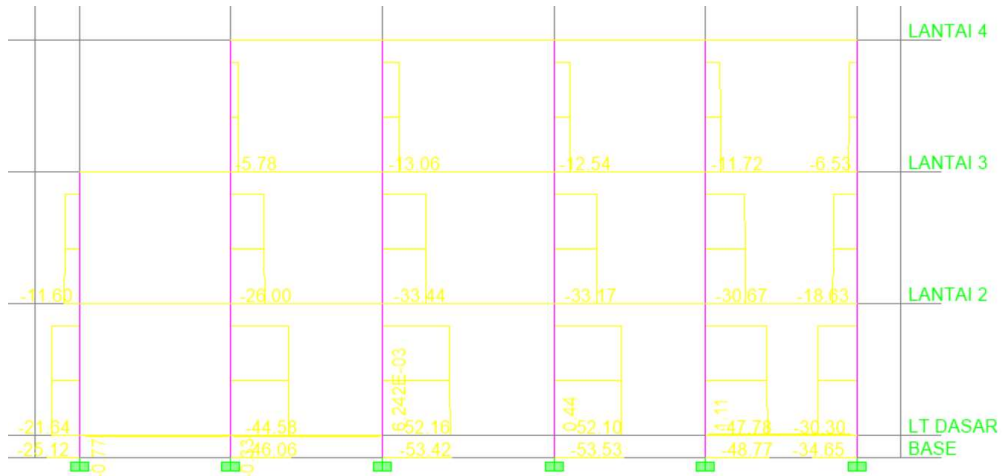
Gambar 4.65 Axial Load yang terjadi pada sampel kolom K2
