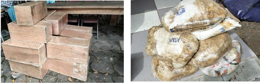
Gambar 3-5 Pengembangan pengambilan tanah tak terganggu dengan Thin Steel Plate Box Sampelr , pengambilan dan pemindahan ke Wooden Box Sampel . Sampel tanah dibawa ke laboratorium mekanika tanah.
