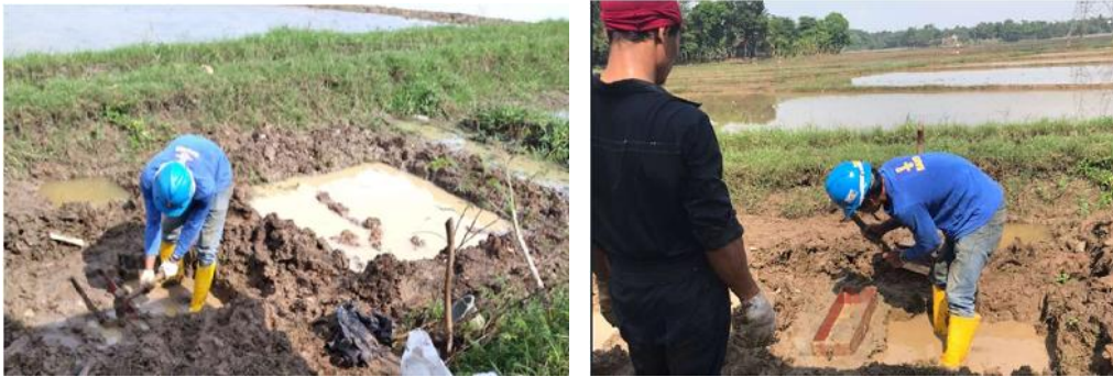
Gambar 3-4 Metode persampelan tak terganggu dengan Thin Stell Plate Box Sampel pada lapangan pada uji galian tanah untuk uji triaxial dan konsolidasi di laboratorium
