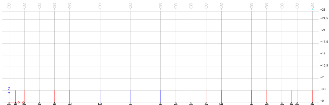
Gambar 2. 26. Kolom Rangka Pemikul Momen Khusus dengan Tumpuan Jepit dan Kolom Rangka Pemikul Gaya Gravitasi dengan Tumpuan Sendi
