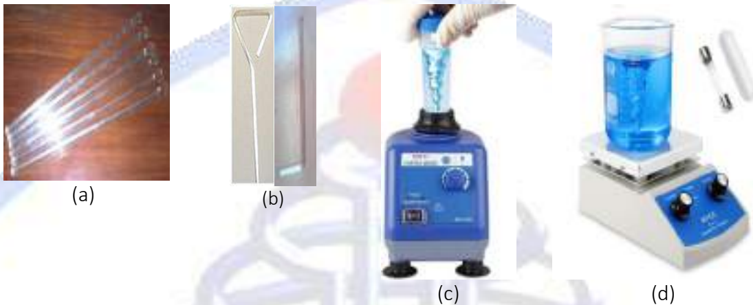
Gambar 2.3 Contoh alat homogenisasi. (a) Batang pengaduk; (b) batang sebar (batang L dan batang segitiga); (c) vortex ; (d) magnetic hot plate dan magnetic stirrer (sumber: amazon.com)
