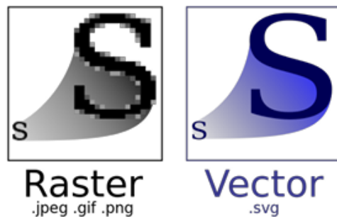
Gambar 2 Perbedaan Gambar Bitmap dengan Gambar Vektor
