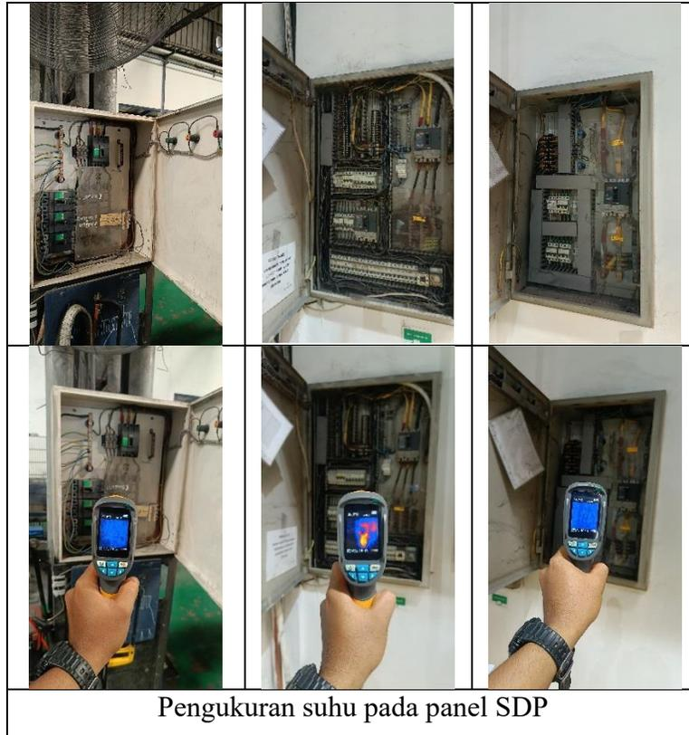
*Gambar 4. 29 Pengukuran Suhu Panel
