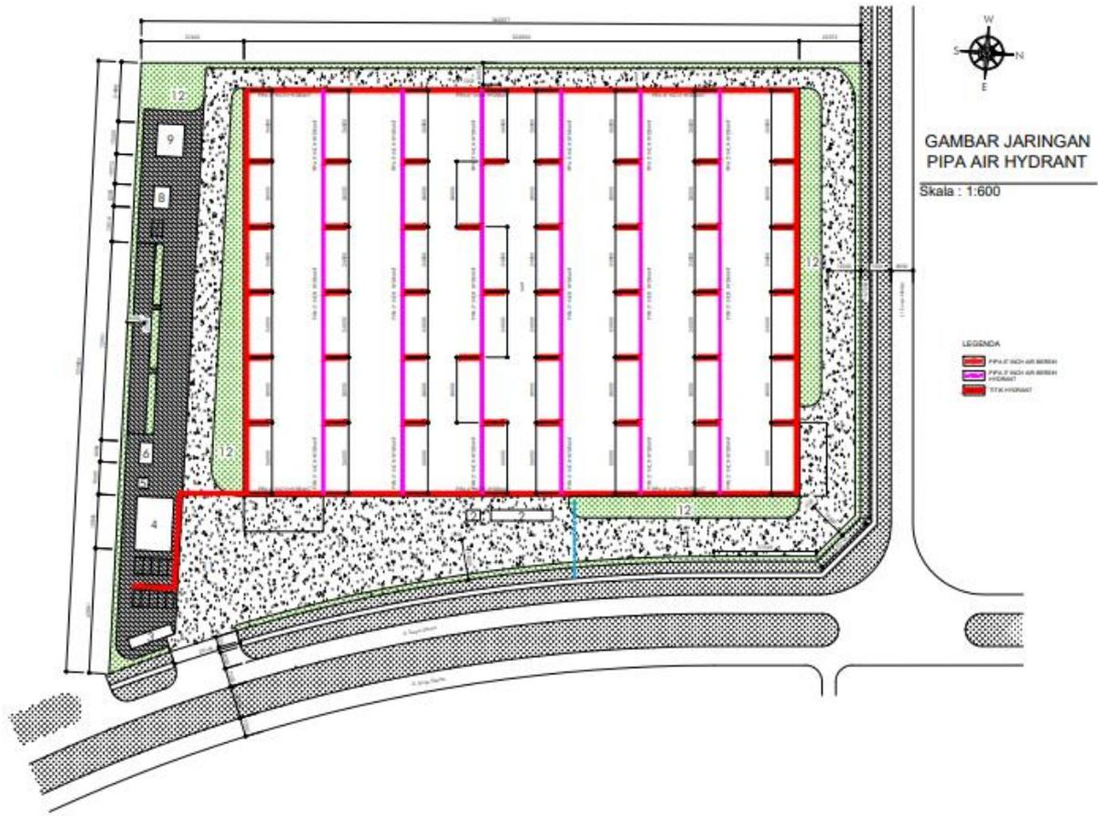
Gambar 4. 30 Detail denah titik lokasi Hydrant
