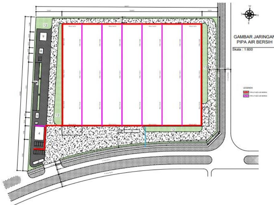
*Gambar 4. 27 Detail instalasi air bersih
