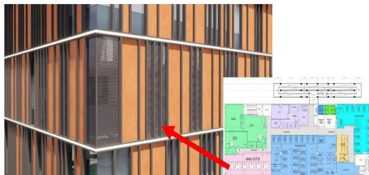
Gambar 4.3 Ventilation Grill pada desain fasad di ruang AHU RS. Islam Faisal Makassar
