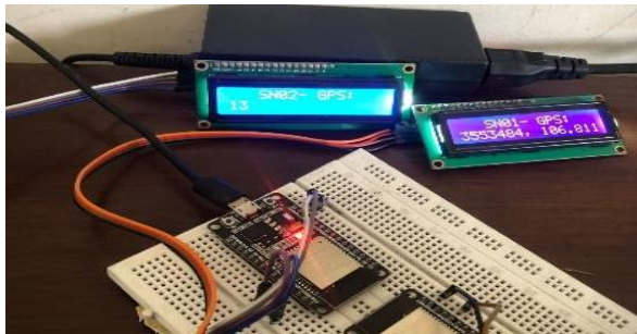
Sumber: (Hasil Penelitian, 2025) Gambar 5. Pembacaan GPS pada perangkat SN01 dilapangan
