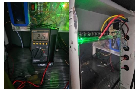
Gambar 4. 1 Hasil Pengukuran Catu Daya 12V 30A Tanpa Beban
