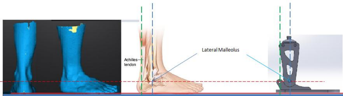
Gambar 4.8 Desain Transtibial Bionic Prosthesis yang meniru anatomi Ankle
