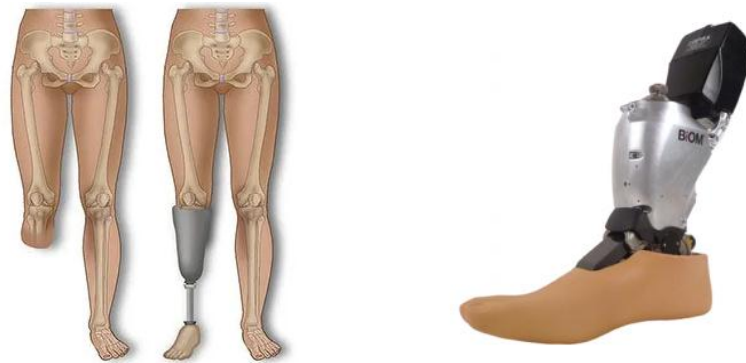
Gambar 2.4 (a) Amputasi Transtibial dan Transtibial Prosthetic (b) iWalk's Power Foot BiOM
