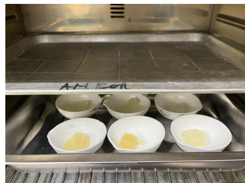
Pemanasan cawan porselen + sampel dalam oven suhu 105 selama 1 jam
