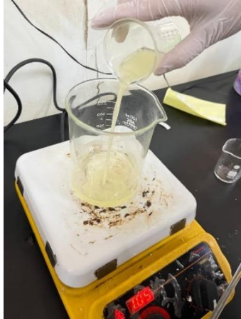
Penambahan hasil Peleburan (aquadest+gliserin+NaOH)
