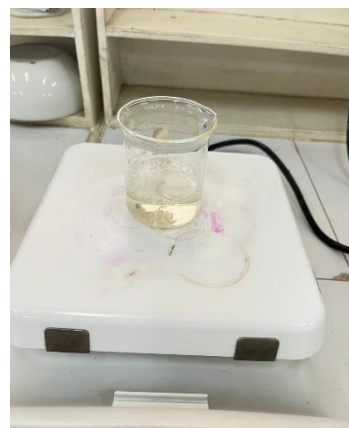
Pelarutan sabun + aquadest dengan hotplate
