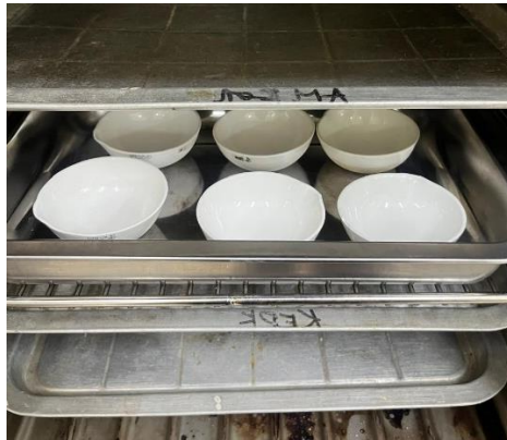
Pengeringan cawan porselen dalam oven suhu 105 selama 30 menit
