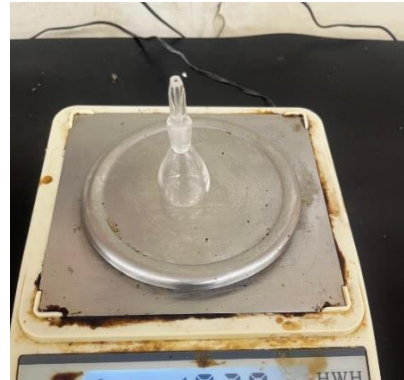
M_1 = masa piknometer berisi air
