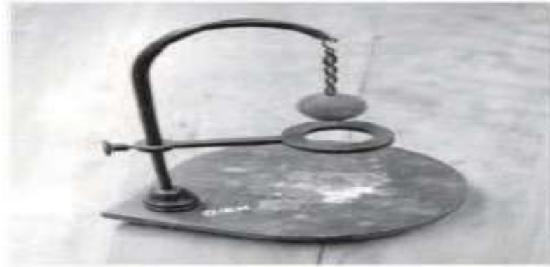
Gambar 9. Alat Ukur Muai Ruang/Muai Volume gelang s'Gravesande
