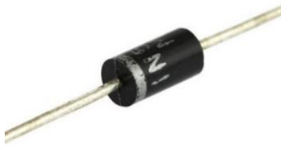
Gambar GM2. 4 Gambar fisik Dioda Penyearah
