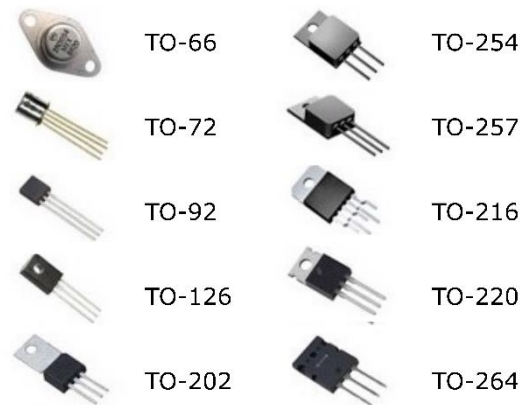
Gambar GM2. 5 Gambar fisik transistor dan jenis kemasannya
