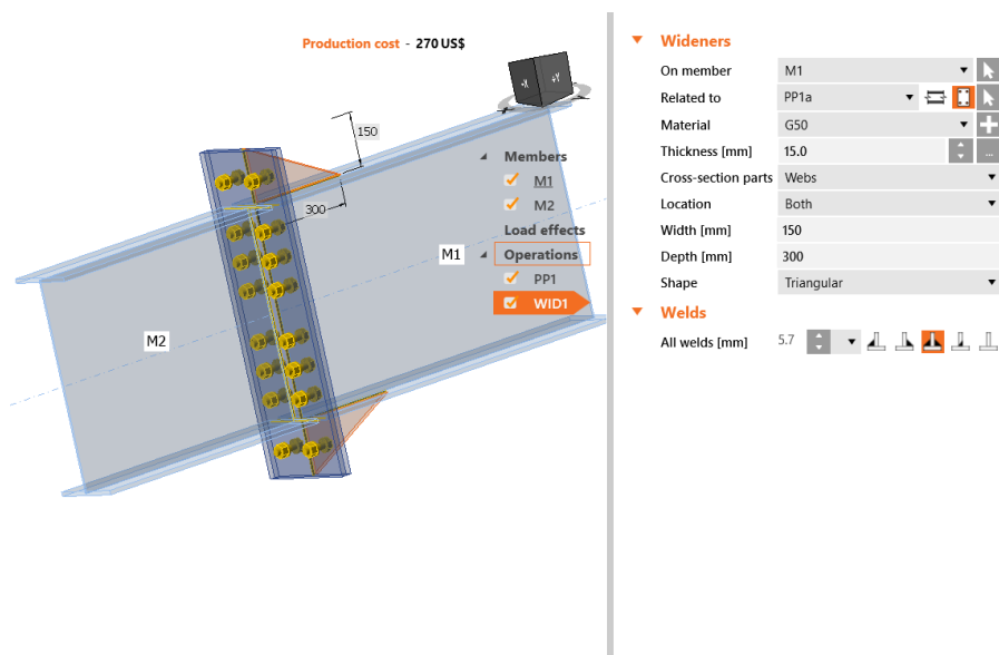
Gambar 6. 13 Properti Haunch bagian kanan
