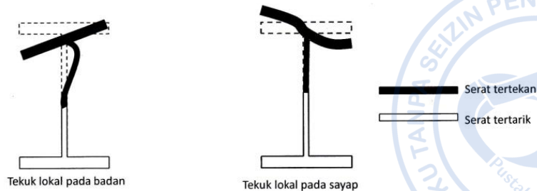
Gambar 1.2 Kegagalan Tekuk Lokal Baja
