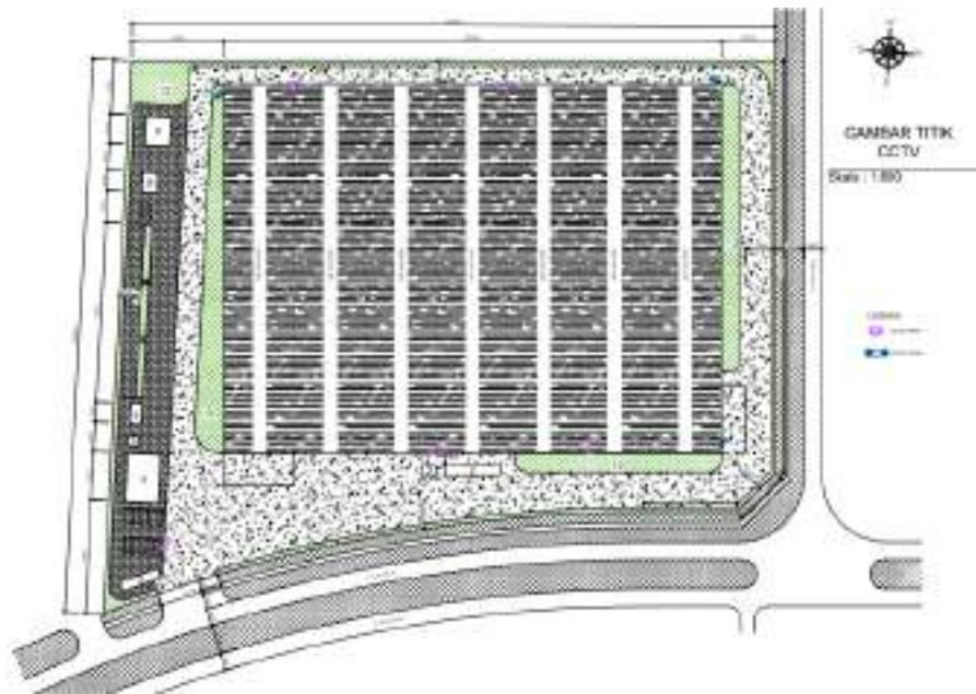
Gambar 4. 26 Lokasi Rencana pemasangan CCTV Sumber: Hasil Pengamatan di lokasi
