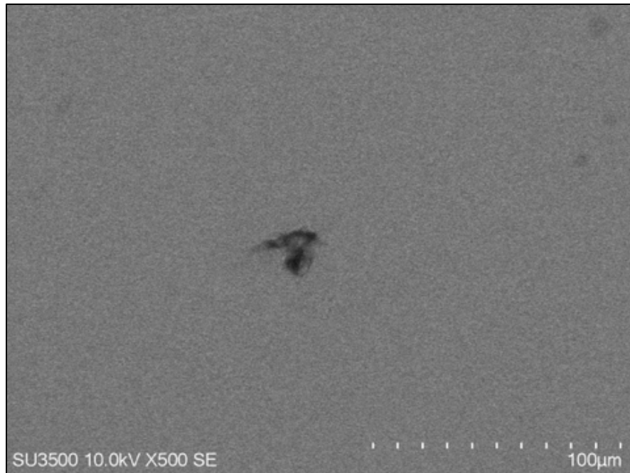
Gambar 4.2 SEM Permukaan Paduan Amorf Zr_{55}Cu_{30}Ni_5Al_{10} Sebelum tanpa perlakuan panas
