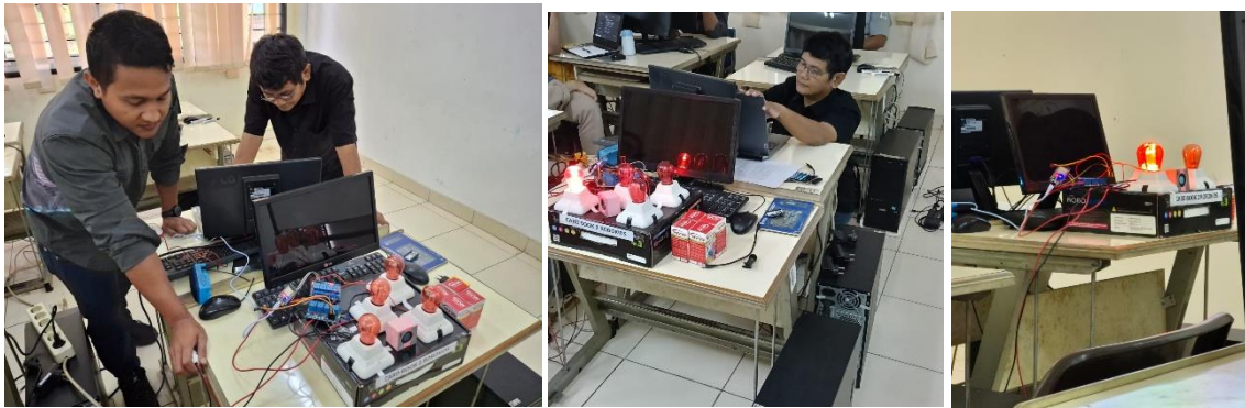
Gambar 8. Persiapan Rangkaian ESP32, Modul Relay , dan Beban Lampu AC
