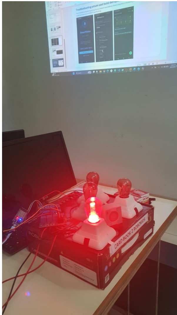
Gambar 12. Pengujian Alat Kendali Lampu AC 220 Volt dengan Perintah Suara
