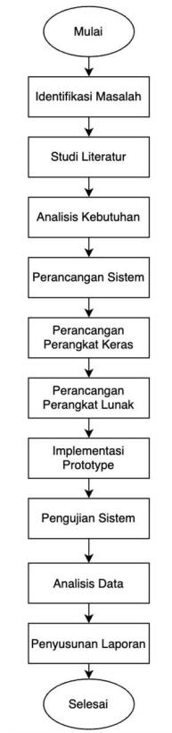
Gambar 3. 1 Tahapan penelitian sistem pemantauan lokasi dan pengiriman sinyal darurat nelayan berbasis Gps dan Lora
