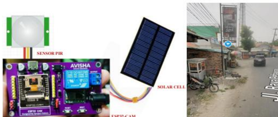
Gambar 6. Sistem Pengawasan Wilayah Berbasis IoT dan Penempatan di Tempat Terbuka
