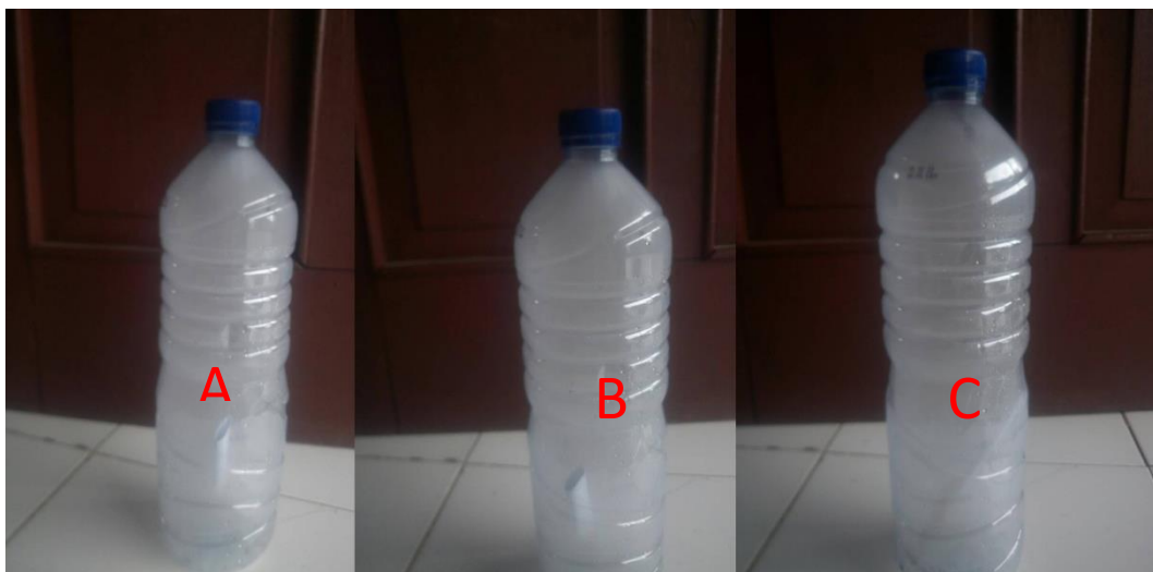
Gambar 4.3 Botol Pengujian Asap Tebal (A), Sedang (B), Tipis (C)
