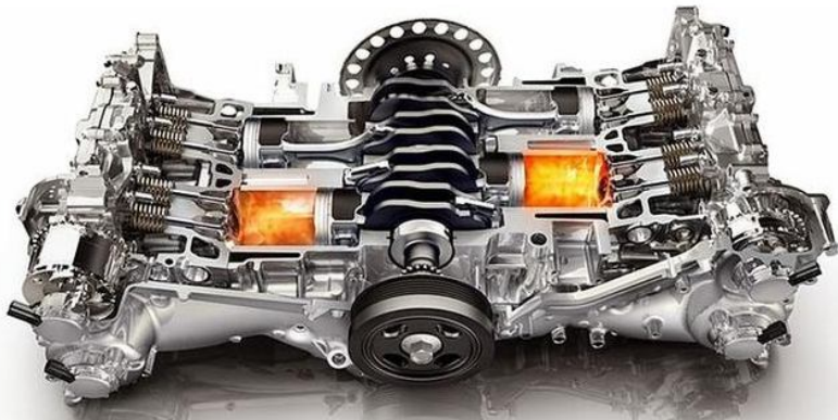
susunan kontruksi silinder pada tipe horizontal secara berlawanan arah di engine
