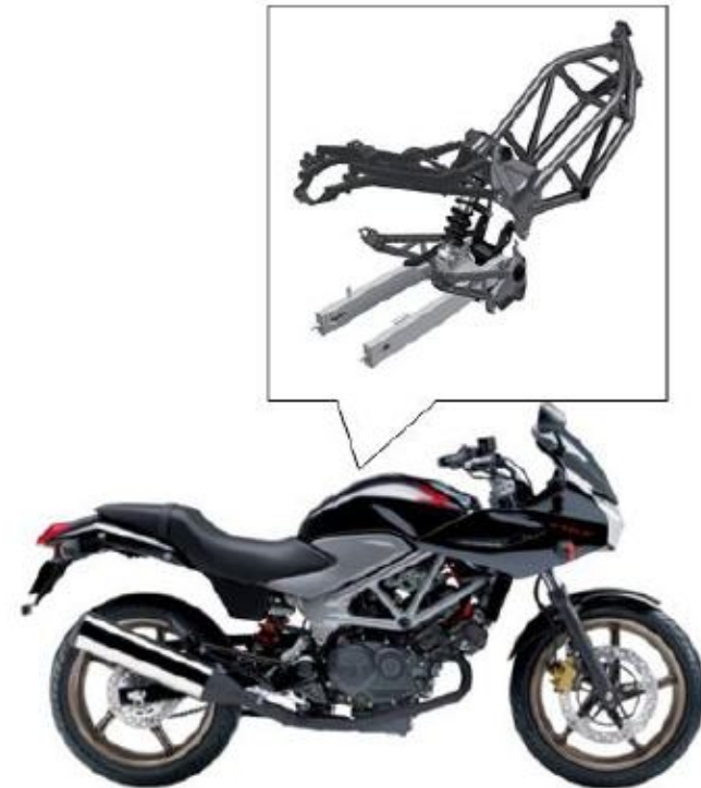
Gambar 1. 8 Motor Dengan Rangka Trellis.
