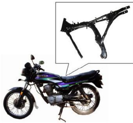
Gambar 1. 4 Motor Sport Dengan Rangka Backbone.
