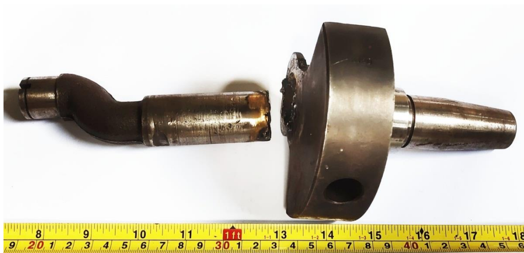
Gambar 3. 3 Kondisi visual crankshaft pasca brazing repair yang patah
