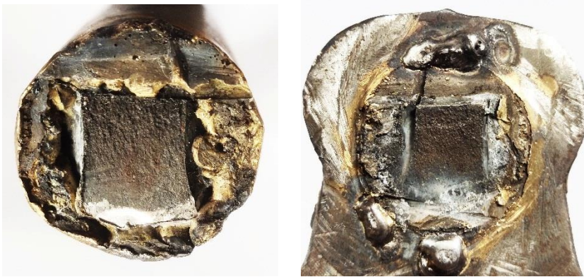
Gambar 3. 4 Pengamatan patahan secara makro
