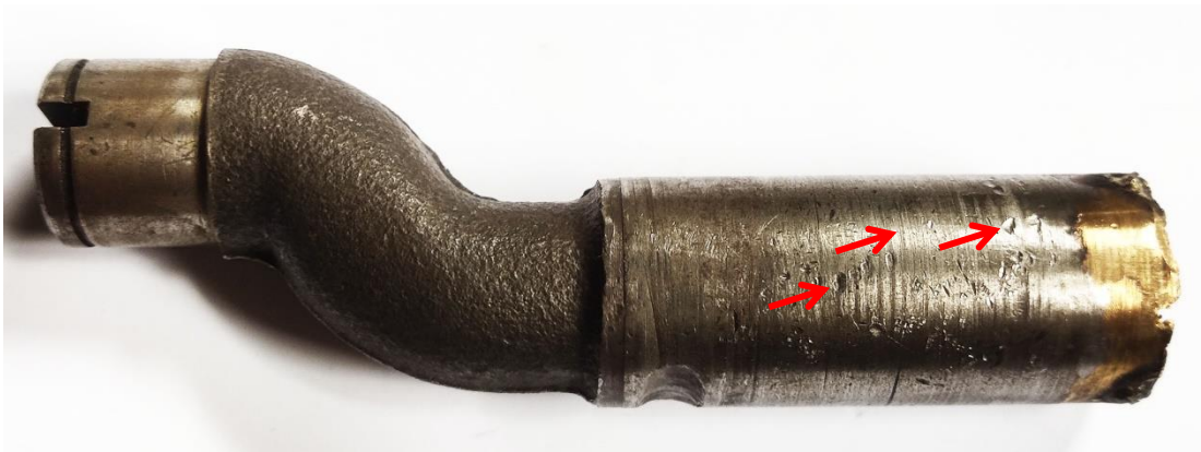
Gambar 4. 3 Cacat dan guratan pada crankshaft
