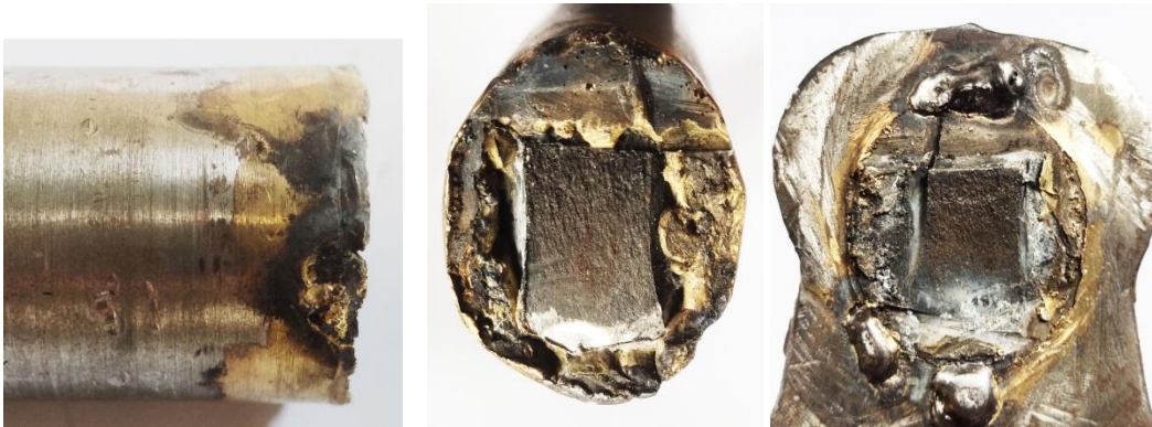
Gambar 4. 11 Pengamatan visual crankshaft yang direkondisi
