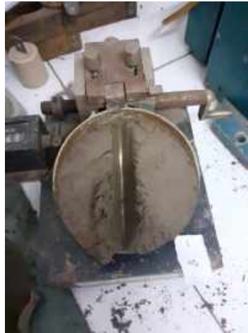
Gambar 3.6 Pembuatan alur benda uji dalam mangkuk Casagrande
