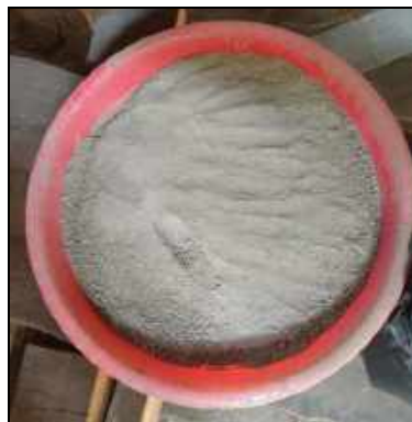
Gambar 3.10 Clay shale yang telah lapuk (lolos ayakan 8)
