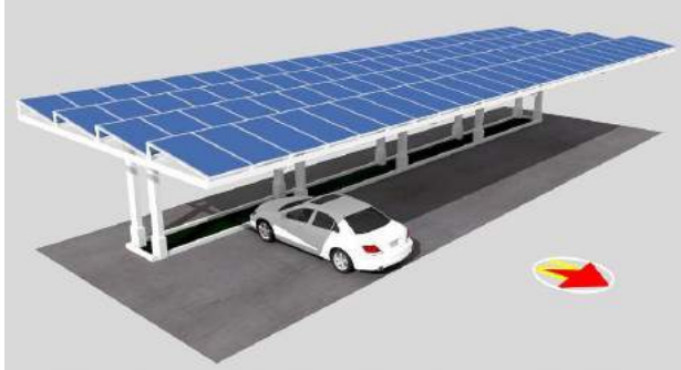
Gambar 6.18 Contoh PLTS rooftop diatas carport (area parkir)
