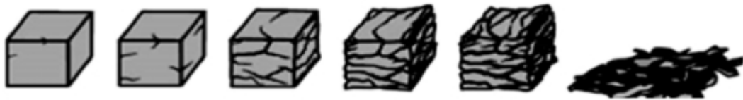
Gambar 2.2 Ilustrasi Proses Umum Keretakan Clay Shale karena Pelapukan akibat Eksposur dari Luar (Sumber : Sadisun et al, 2006)
