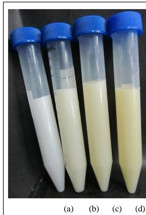
Gambar 4.13. Penampilan sediaan krim setelah sentrifugasi 3750 rpm selama 5 jam (a) blanko; (b) KL 5%; (c) KL 10%; (d) KL 15%
