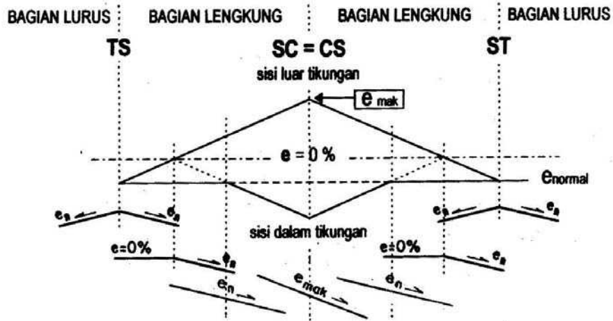
Gambar 3.13. Pencapaian superelevasi pada tikungan SS (contoh tikungan ke kanan)
