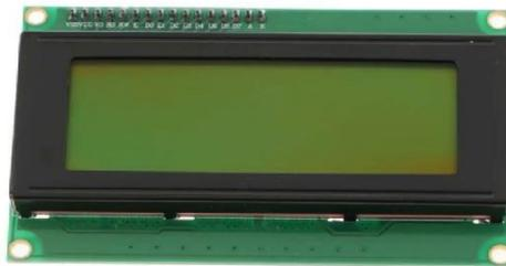
**Gambar 19.** LCD 20x4 dengan I2C
