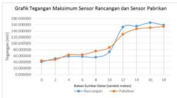
Gambar-19: Grafik Tegangan Maksimum Sensor Rancangan dan Sensor Pabrikan terhadap Besaran Sumber Getar
