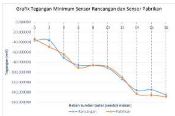
Gambar-20: Grafik Tegangan Minimum Sensor Rancangan dan Sensor Pabrikan terhadap Besaran Sumber Getar
