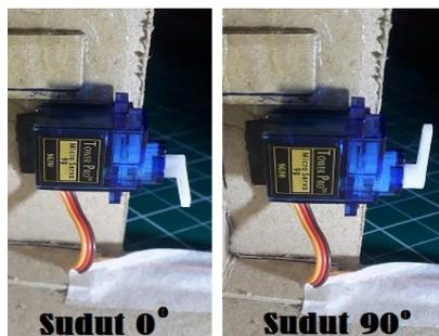
**Gambar 7** Pengujian Buka Tutup pintu Ruang Kelas Menggunakan Servo
