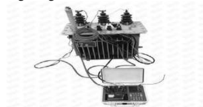
Gambar 11. Gambar skematik transformator dan TTR
