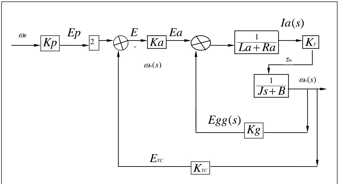
Blok diagram lengkap dari sistem servo mekanis Pengaturan Kecepatan Motor DC
