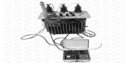
Gambar 11. Gambar skematik transformator dan TTR
