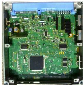
Gambar 2.20 *Electronic Control Unit*(ECU)
