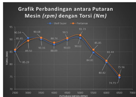
Gambar 4. 1. Perbandingan antara Putaran Mesin (rpm) dengan Torsi (Nm)
