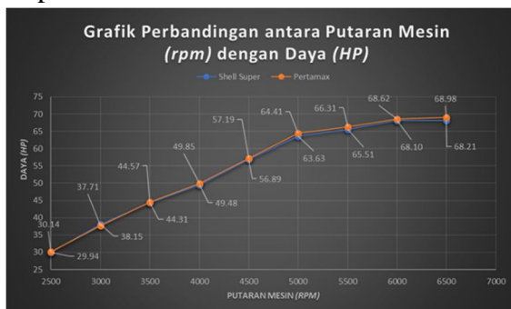
Grafik 4. 1. Perbandingan antara Putaran Mesin (rpm) dengan Daya (HP)
