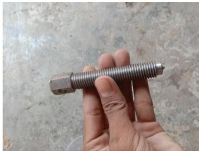
**Gambar 4.23** Hasil Pembuatan As Pendorong Tracker Magnet
