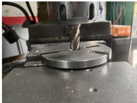
**Gambar 4.33** Posisi *Endmill Cutter* Pada Mesin Frais
