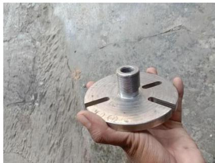
**Gambar 4.35** Hasil pembuatan piringan tracker magnet
