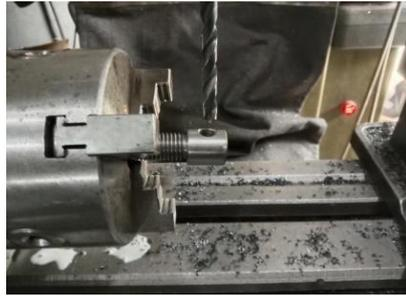
**Gambar 4.22** Proses Pembentukan Menggunakan Endmill Cutter
