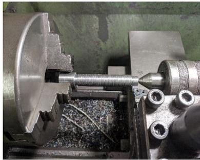
**Gambar 4.16** Proses Pemakanan Samping As Pendorong
