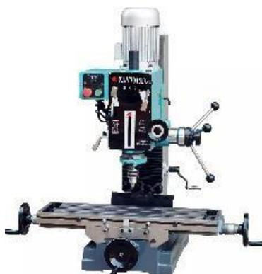
**Gambar 3.3** Mesin Frais (*Milling*)
