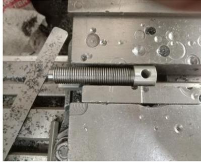
**Gambar 4.19** Posisi As Pendorong Pada Mesin Frais
