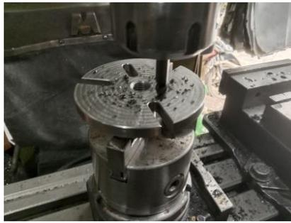
**Gambar 4.34** Proses pembuatan alur profil piringan
