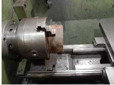
**Gambar 4.25** Posisi Bahan Piringan Di Mesin Bubut
