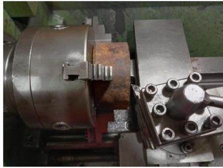
**Gambar 4.28** Proses Pemakanan Samping Piringan
