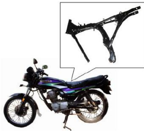
Gambar 1. 4 Motor Sport Dengan Rangka Backbone.
