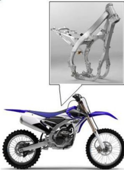
Gambar 1. 6 Motor Dengan Rangka Single Cradle.
