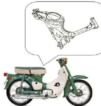
Gambar 1. 5 Motor Cup Dengan rangka Backbone.
