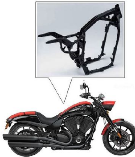
Gambar 1. 7 Motor Dengan Rangka Double Cradle.
