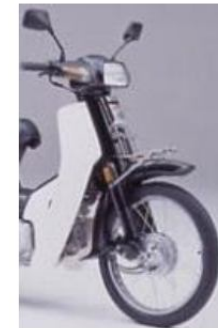
Gambar 1. 13 Sistem Kemudi Jenis Pressed Steel
