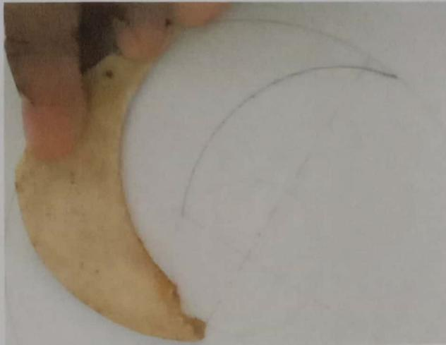
Gambar 4.5 Pelukisan bentuk profil sudu Impeller.
