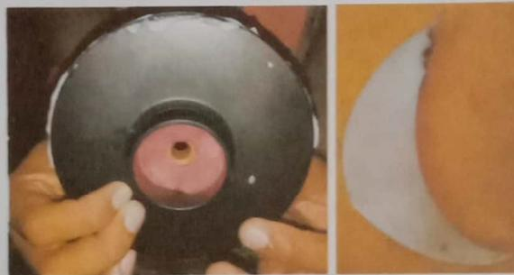
Gambar 3.6 Proses pencetakan Profil Impeller menggunakan karet silikon
