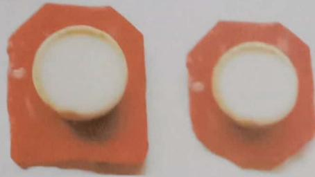
Gambar 3.5 Pengujian pencampuran karet silikon dengan hardener serta melihat apakah ada penyusutan pada hasil cetakan.
