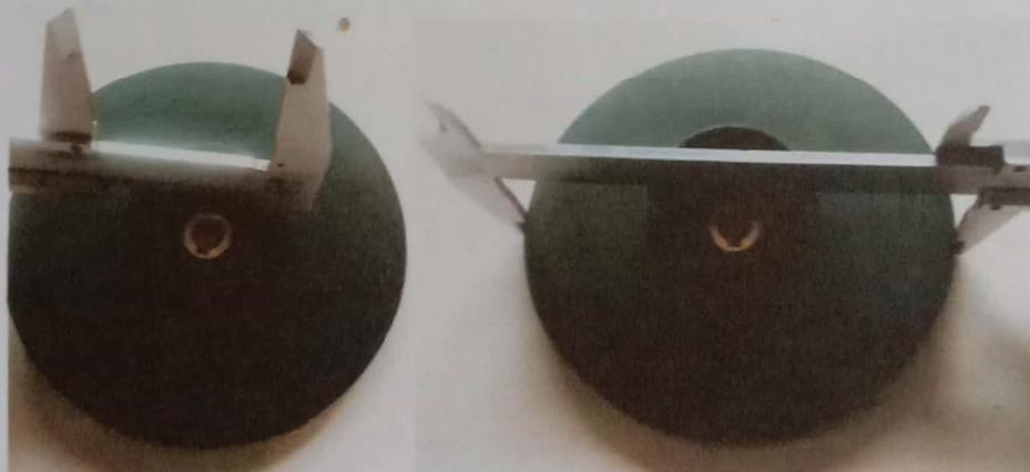
Gambar 4.1. Pengukuran diameter dalam ( $D_1$ ) dan diameter luar ( $D_2$ ) impeller
