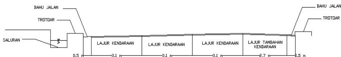
Gambar 3. Potongan Melintang Jalan Pada Lokasi Perlintasan
