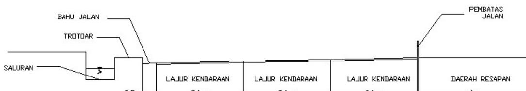
Gambar 2. Potongan Melintang Jalan pada Lokasi Sebelum Perlintasan
