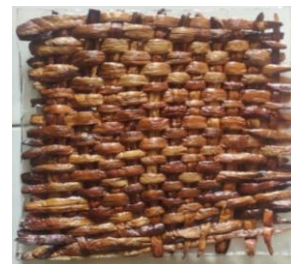
Gambar 4. Spesimen komposit berpenguat filler 40% serat batang eceng gondok
