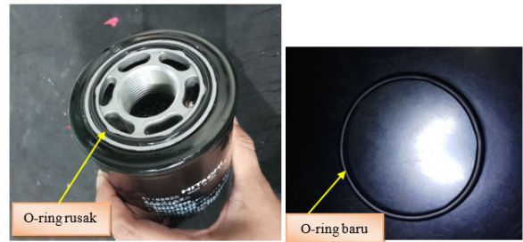
Gambar 6. Perbedaan o-ring yang rusak dan yang baru
