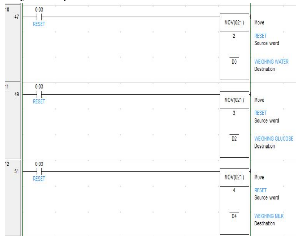
Gambar 4.24 Ladder reset water, glucose, milk Ketika tombol reset (channel 0.03) ditekan, nilai actual (PV) semua weighing dan timer akan
