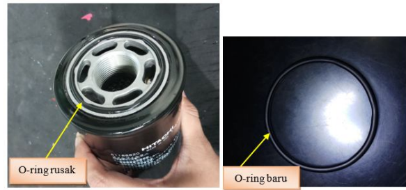
Gambar 6. Perbedaan o-ring yang rusak dan yang baru
