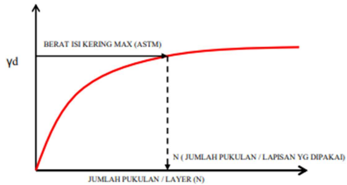
Gambar. 2. 5 Penentuan jumlah pukulan/lapisan dengan Trial Compaction (idrus, 2006)
