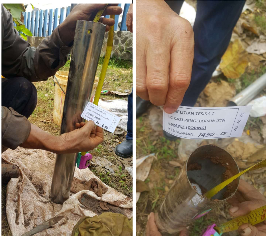
Gambar 3.6 Pengukuran dan pelabelan contoh tanah tidak terganggu
