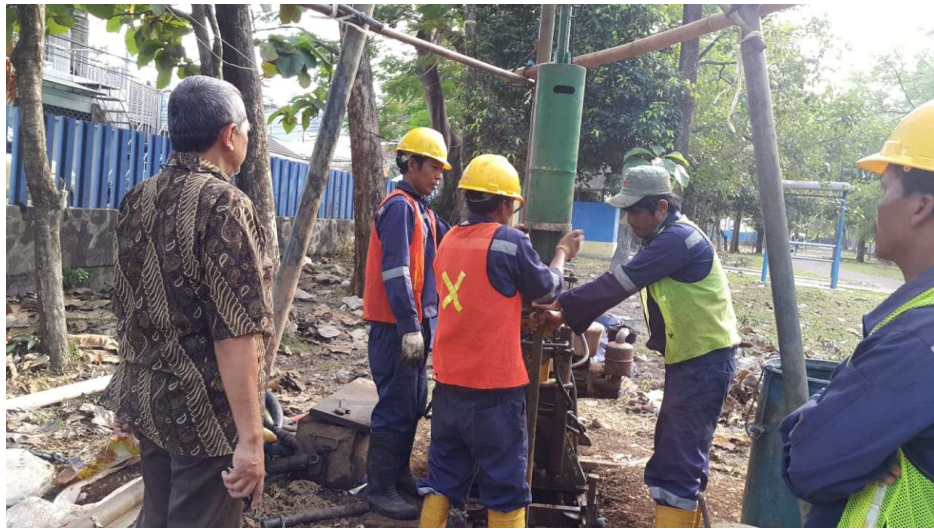
Gambar 3.5. Pelaksanaan pengujian Standard Penetration Test (SPT)
