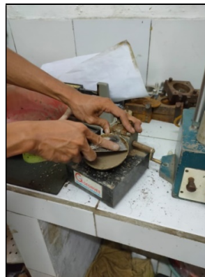
Gambar 3.5 Proses perataan benda uji dalam mangkuk Casagrande
