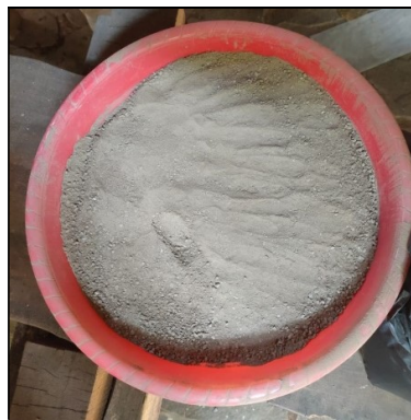
Gambar 3.10 Clay shale yang telah lapuk (lolos ayakan 8)
