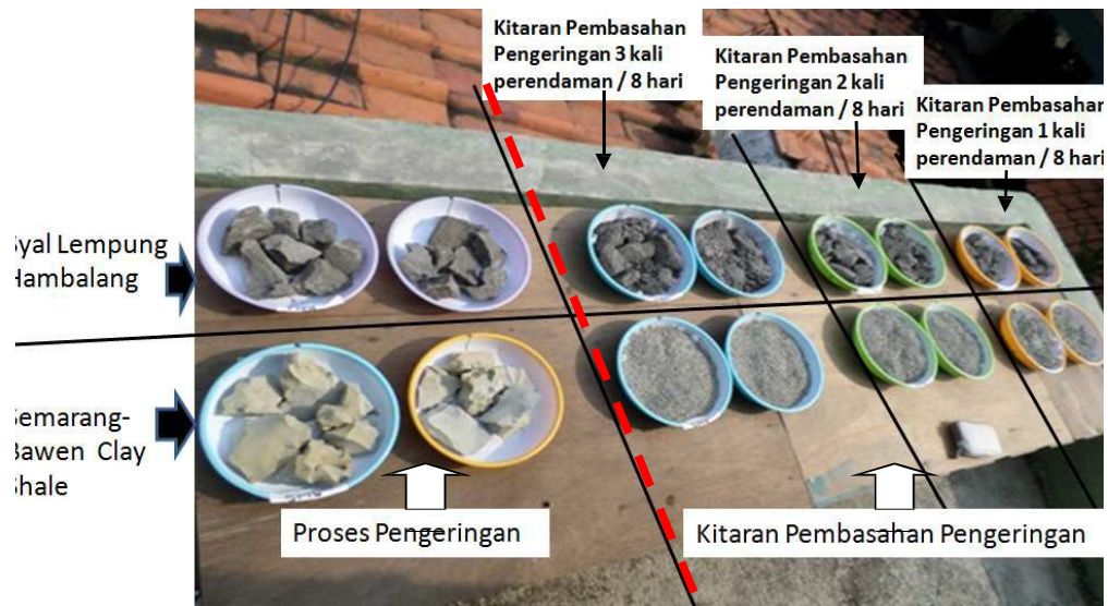
Gambar 2.5 Perubahan sifat fisik clay shale Semarang-Bawen dan Hambalang terhadap proses pengeringan dan siklus pembasahan-pengeringan (Alatas I.M., 2017).
