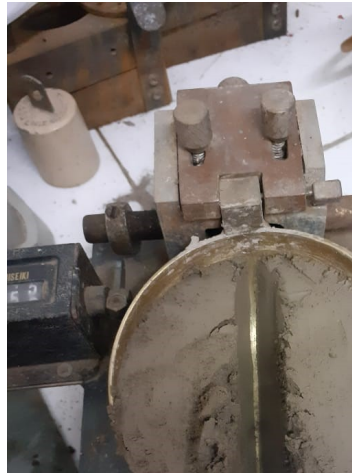
Gambar 3.6 Pembuatan alur benda uji dalam mangkuk Casagrande
