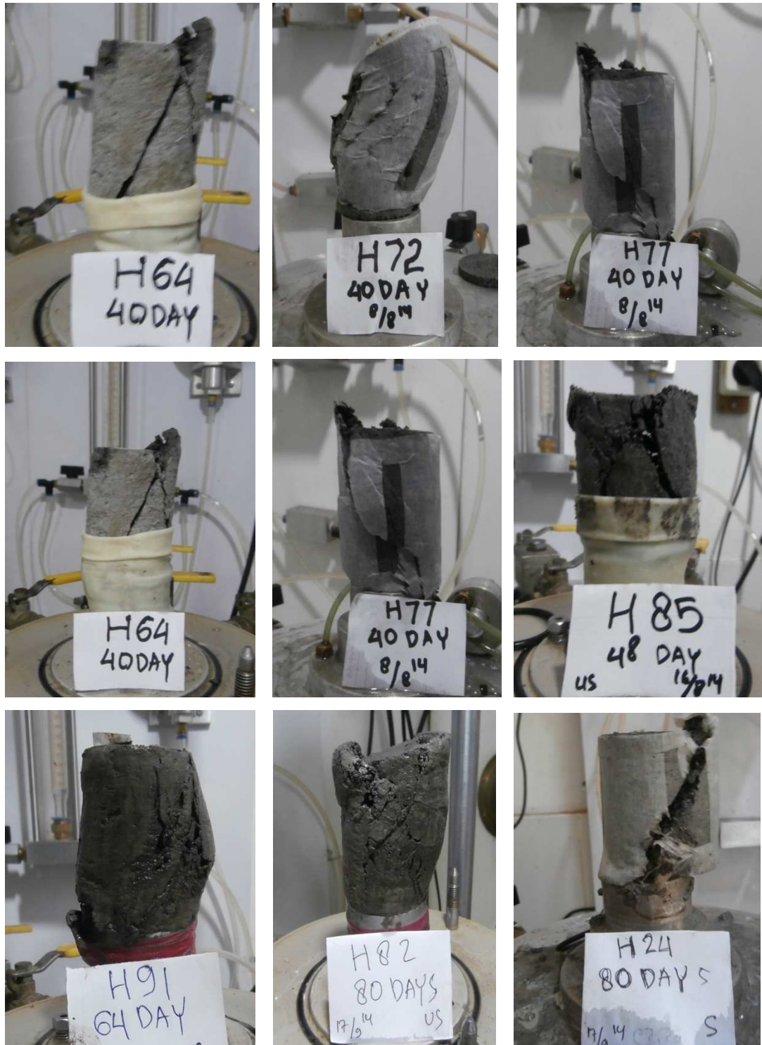
Gambar 4.23 Gambar sudut joint hasil penelitian clay shale Hambalang tak jenuh dan jenuh dari triaksial di laboratorium (sampel 40 hari hingga 80 hari)
