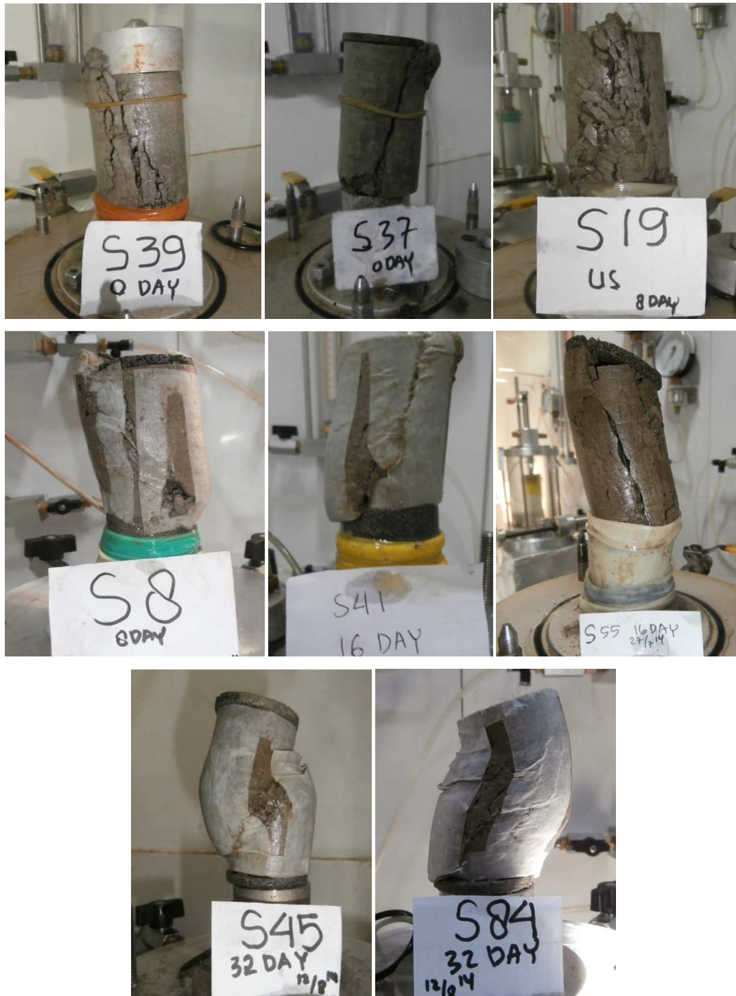
Gambar 4.20 Gambar sudut joint hasil penelitian clay shale Semarang-Bawen tak jenuh dan jenuh dari triaksial di laboratorium (sampel 0 hari hingga 32 hari)
